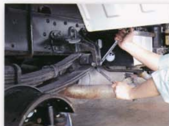
⑤制動装置 （ディスクキャリパ、ブレーキドラムの取り外し）
