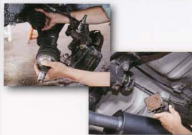
②動力伝達装置 （ドライブシャフト、プロペラシャフト脱着）
