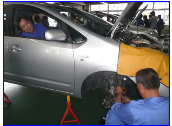
振興会講師による専用機器を使用しない ブレーキフルード交換実習
