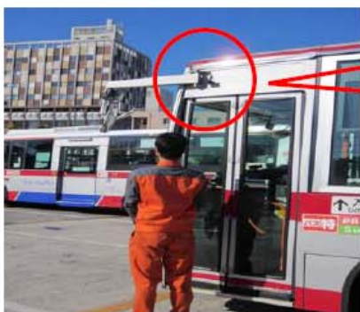
車外カメラを車体に直接取付けた例
