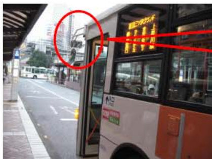
車外カメラを後写鏡ステーに取り付けた例
