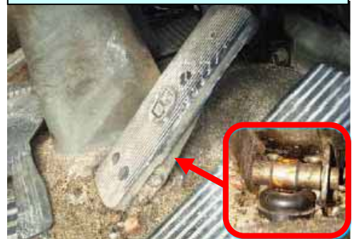
ブレーキ・ペダル下部 異物の付着例 （周辺に泥、砂などが堆積）
