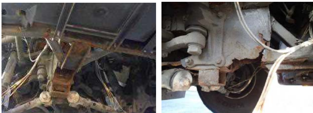
事故車のセンターメンバの腐食状態
