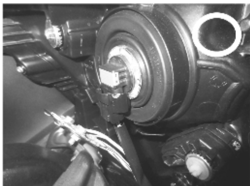
＜正常な取り付け状態＞ ランプ点灯時、光漏れなし
