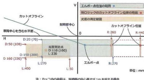
②配光の最も明るい位置が照明部の中心を含む水平面より下方にあるもの。（試験機が測定したカットオフラインではエルボ一点を判断できない場合。）
