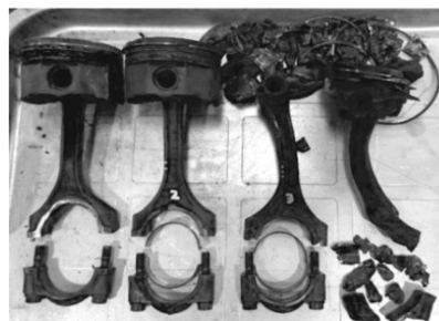
破損したピストン、コンロッド
