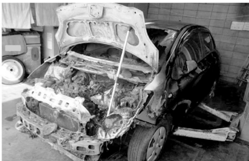
エンジンルーム内に置き忘れた可燃物が原因の車両火災
