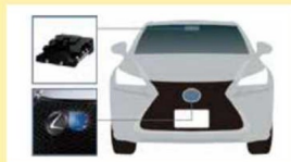
カメラ・ミリ波レーダー複合型 (レクサスHPより)
