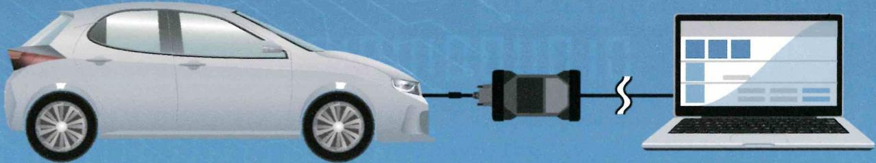
『OBD 検査』とは、自動運転技術などに用いられる電子制御装置が適切に機能しているかを確認する検査です。国の定める自動車検査（車検）の検査項目として、令和 6 年 10 月以降（輸入車は令和 7 年 10 月以降）に新たに追加されました。
