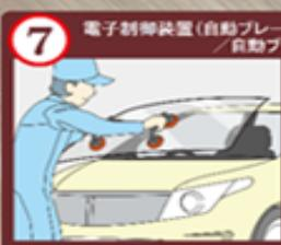
7 電子制御装置(自動ブレーキ用センサーなどが設置されているフロントガラス、グリル・バンパーの脱着/自動ブレーキ用センサーなどの脱着・調整)
