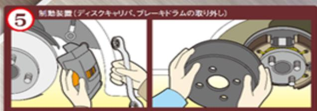
5 制動装置(ディスクキャリバー、ブレーキドラムの取り外し)
