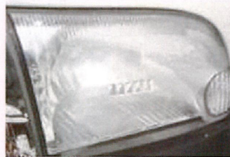
内部リフレクタの劣化
