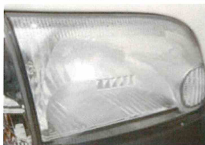
内部リフレクタの劣化
